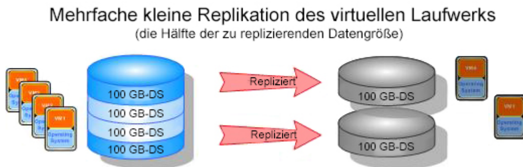
Abbildung 3. Replikation mehrerer virtueller Laufwerke
